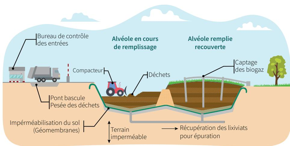
Le centre d'enfouissement n'est pas une simple "décharge" mais une installation contrôlée permettant de limiter les impacts sur l'environnement. Les gaz dus à la fermentation sont utilisés pour la production d'énergie. Les jus - appelés "lixiviats" - subissent quant à eux une dépollution et de nombreux contrôles avant d'être rejetés.
